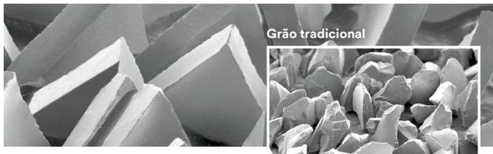
Os abrasivos 3M™ Cubitron™ II contêm grãos pontiagudos calibrados que permitem um corte limpo do metal.
